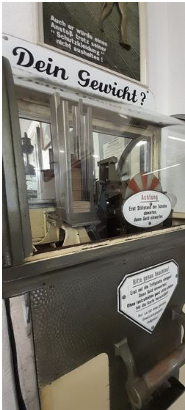
Deutlich sichtbar ist der Schacht mit den auszuwerfenden Gewichtskärtchen
