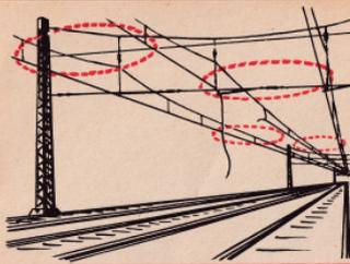
**Herabhängende, gerissene Leitungen** nicht berühren, auch wenn Sie abgeschaltet sind. Sie dürfen erst dann berührt werden, wenn sie außerdem **geerdet** sind, um etwaige Induktionsströme abzuleiten.
