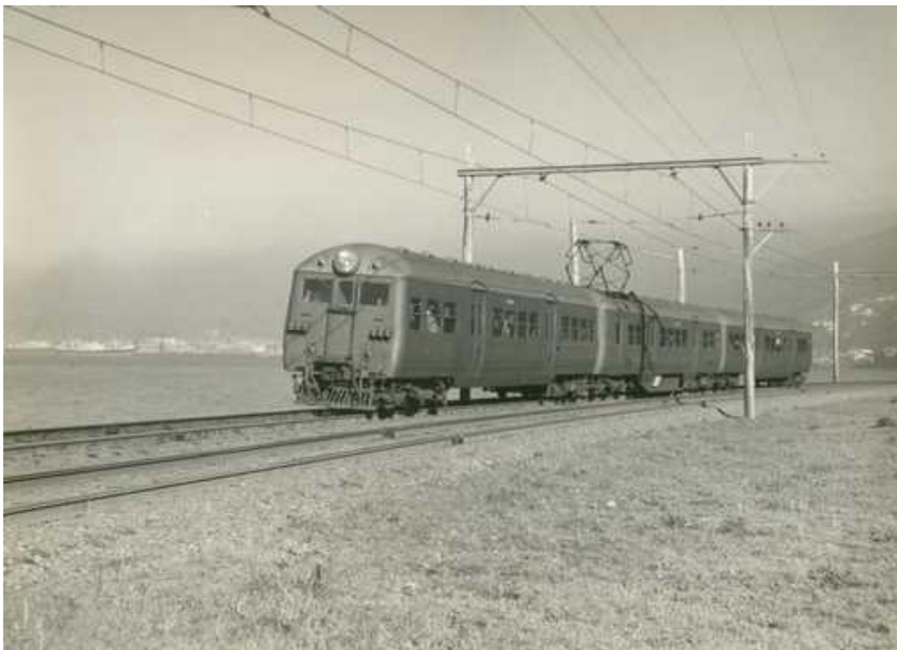
NZR Elektrotriebwagen „D“ Anhänger und “Dm” Motorwagen.
