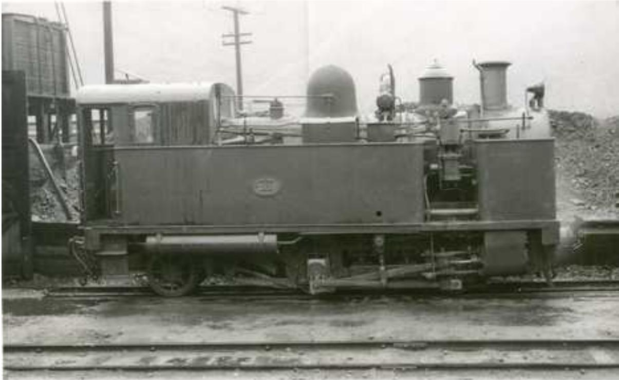
NZR **H-Class 203** 0-4-2T. 6 Stück, 1886 wurden 4 "Fell Locomotives" gebaut bei Avonside Engine Co., 2 bei Nelson & Co.
