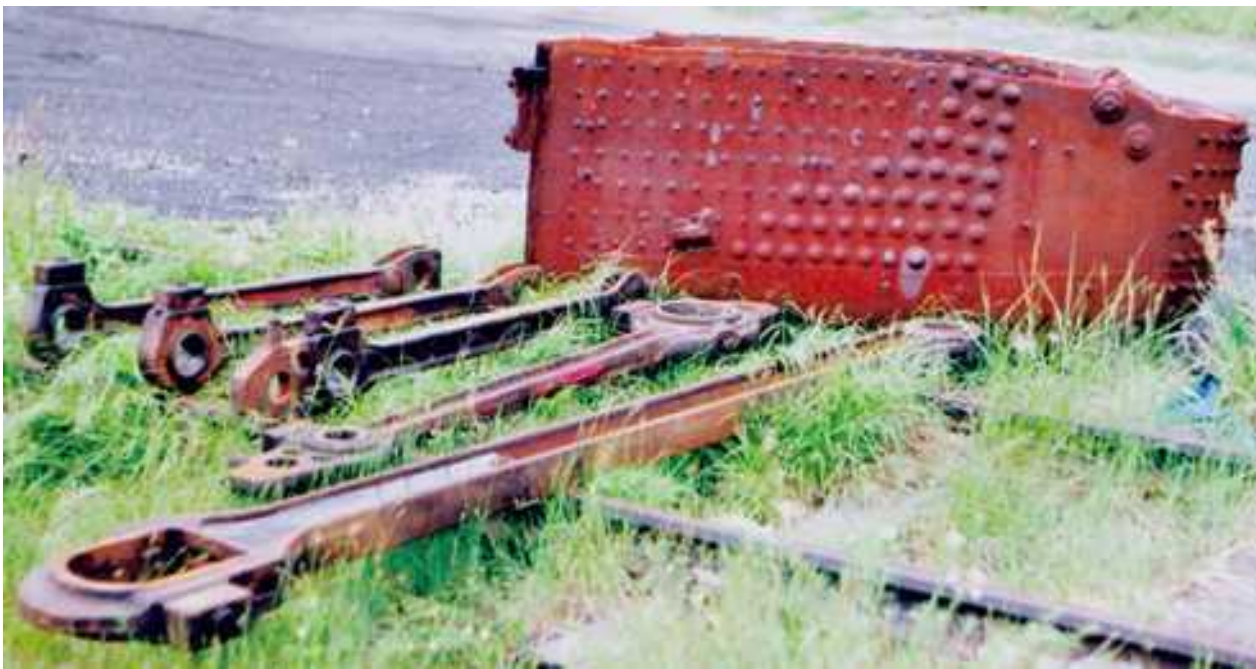
Reste einer Dampflokomotive - wenige Stangen und ein Stehkessel
