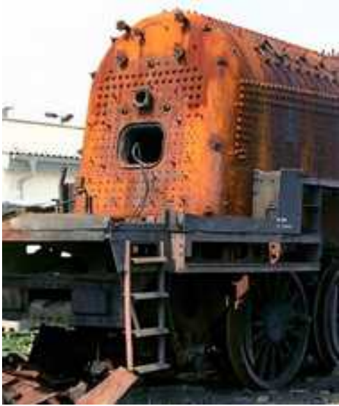
Der Stehkessel der 52 8119 während der Verschrottung
