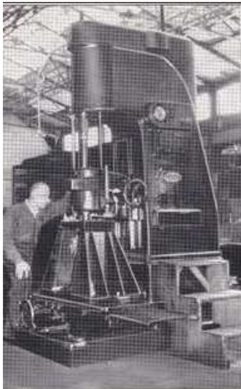
Bohren von Drainagen-Zylindern auf dem Feinbohrwerk „Krause“
