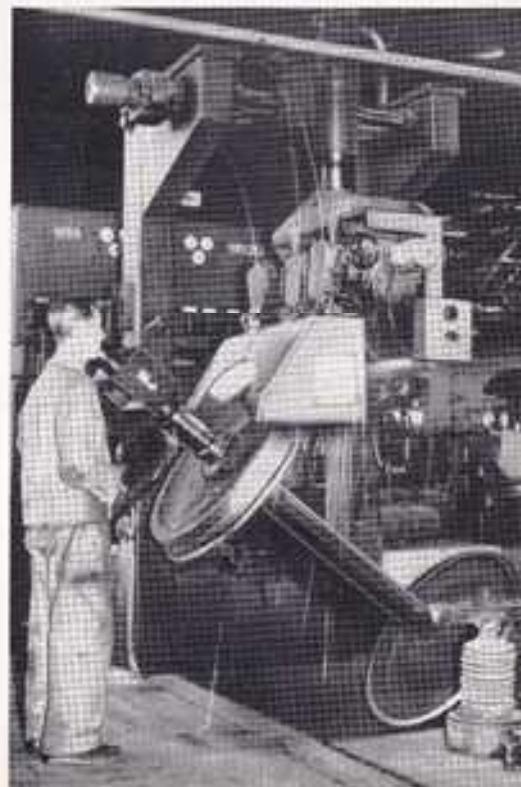
Aufschweißen von Radreifen auf der automatischen Spurkranzschweißmaschine
