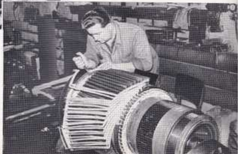
Einbauen von Ankerstäben in einen Generator
