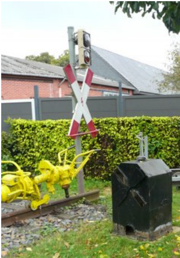
Die beiden Andreaskreuze und die seltene große Doppelkreuzweichenlaterne
