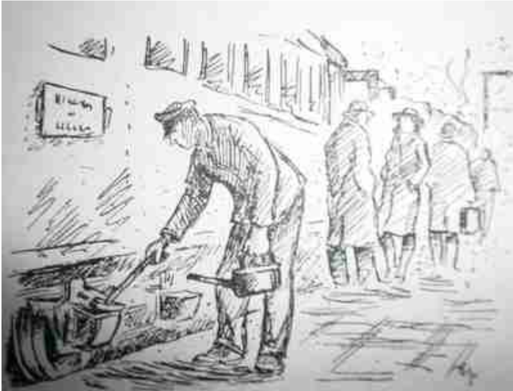
Kontrolle der Achsbüchsen auf einem Unterwegshalt
