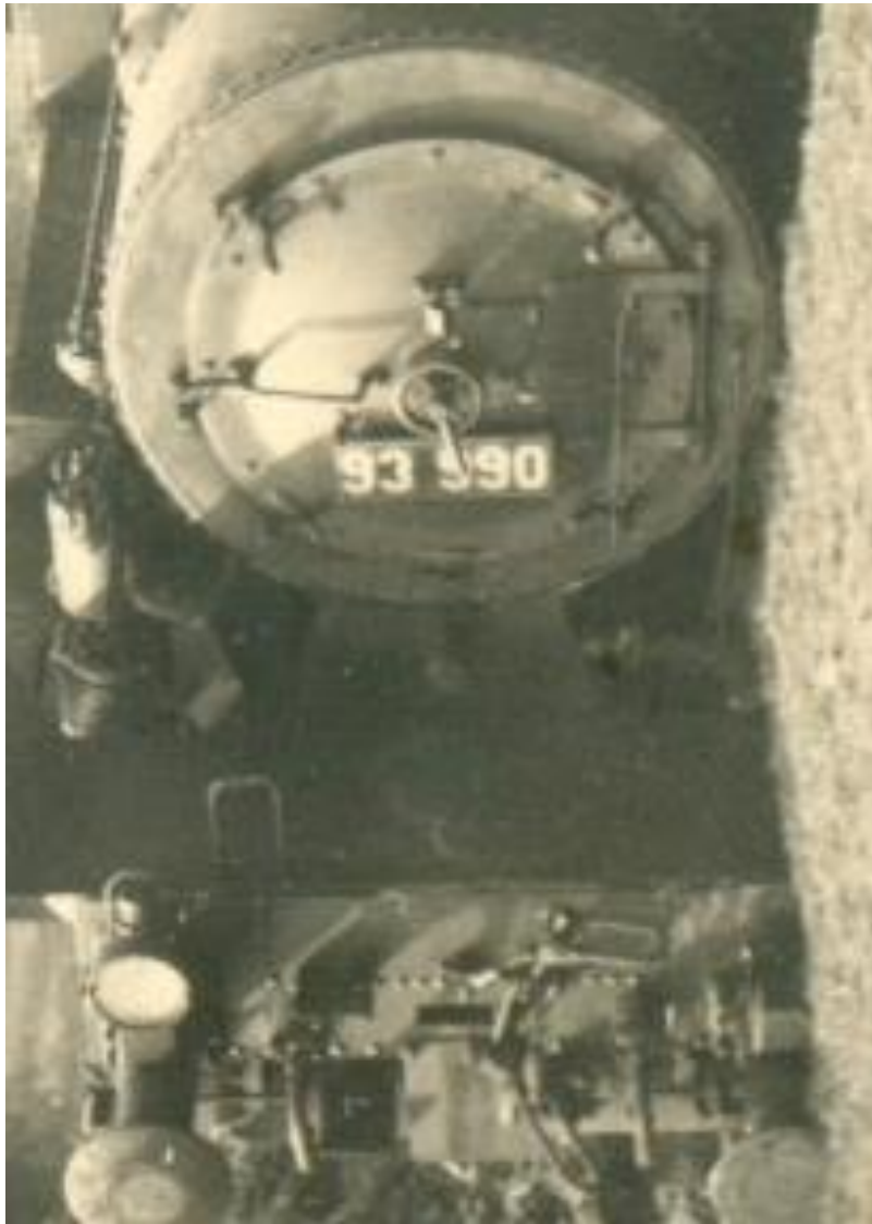
Die Rauchkammer der Lok mit Zentralverriegelung, selbst die linke Laterne ist noch am Platz
