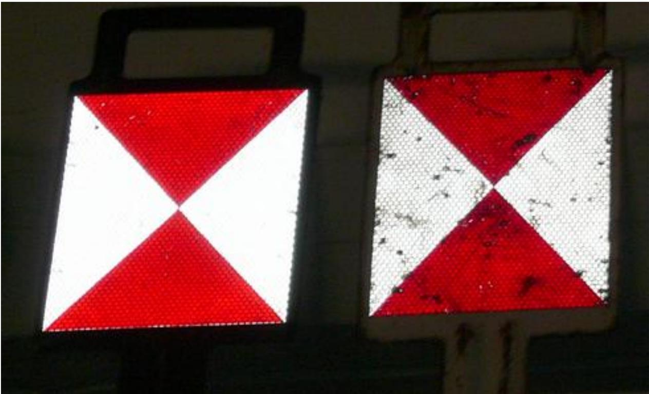
„Ein Zugschlußsignal wird im Eisenbahnbetrieb am Ende eines Zuges verwendet und kennzeichnet den Zugschluß. Mit seiner Hilfe wird die Vollständigkeit von Zügen durch Strecken- oder anderes zugelassenes Personal visuell festgestellt, und zwar entweder durch Augenschein (direkte Zugbeobachtung) oder durch Fernbeobachtungsanlagen (Kamera und Monitor).
