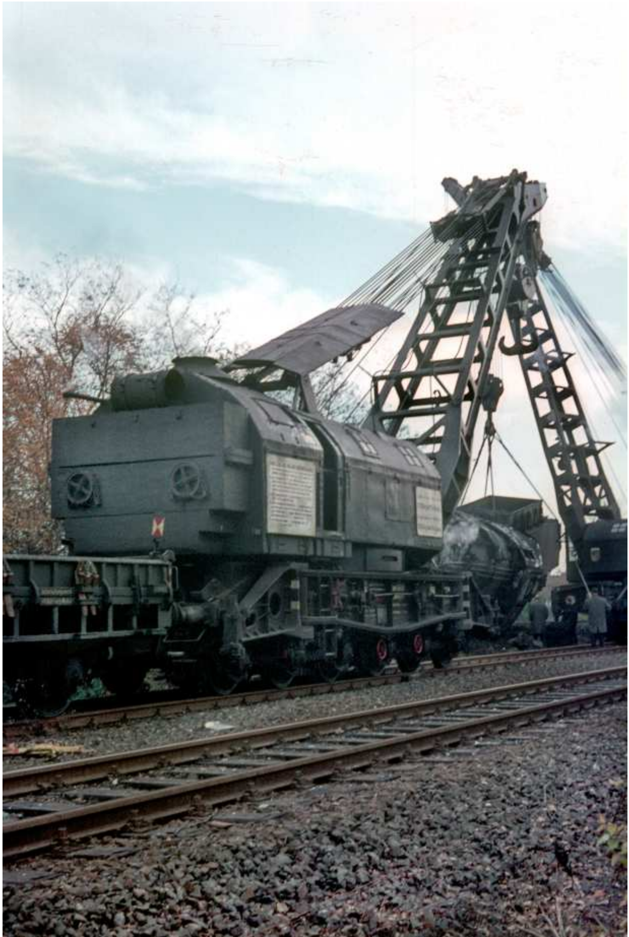
Zwei Dampfkrane sind im Einsatz beim Bergen von Lok und Tender von 44 916
