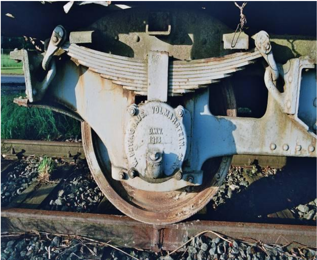
Achslagerdeckel DWV von 1913, W. Beyinghaus, Volmarstein, 1923
