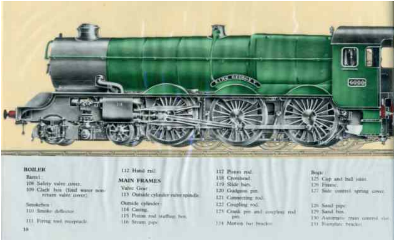
Kessel, Rahmen und Fahrwerk auf der Heizerseite
