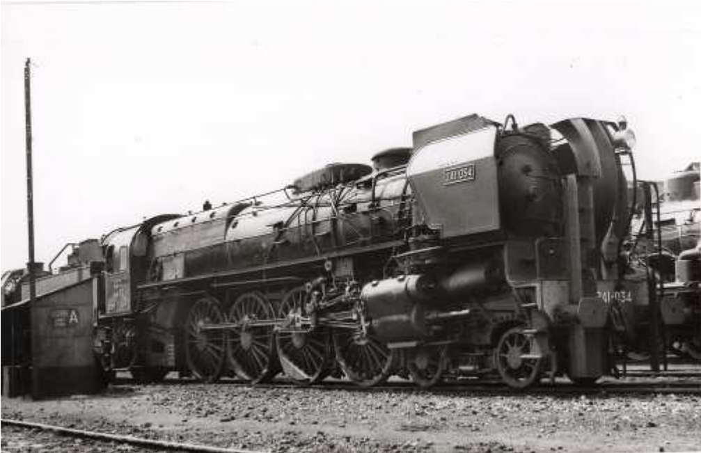
EST 241-034 mit Versuchseinrichtungen auf der vorderen Pufferbohle
