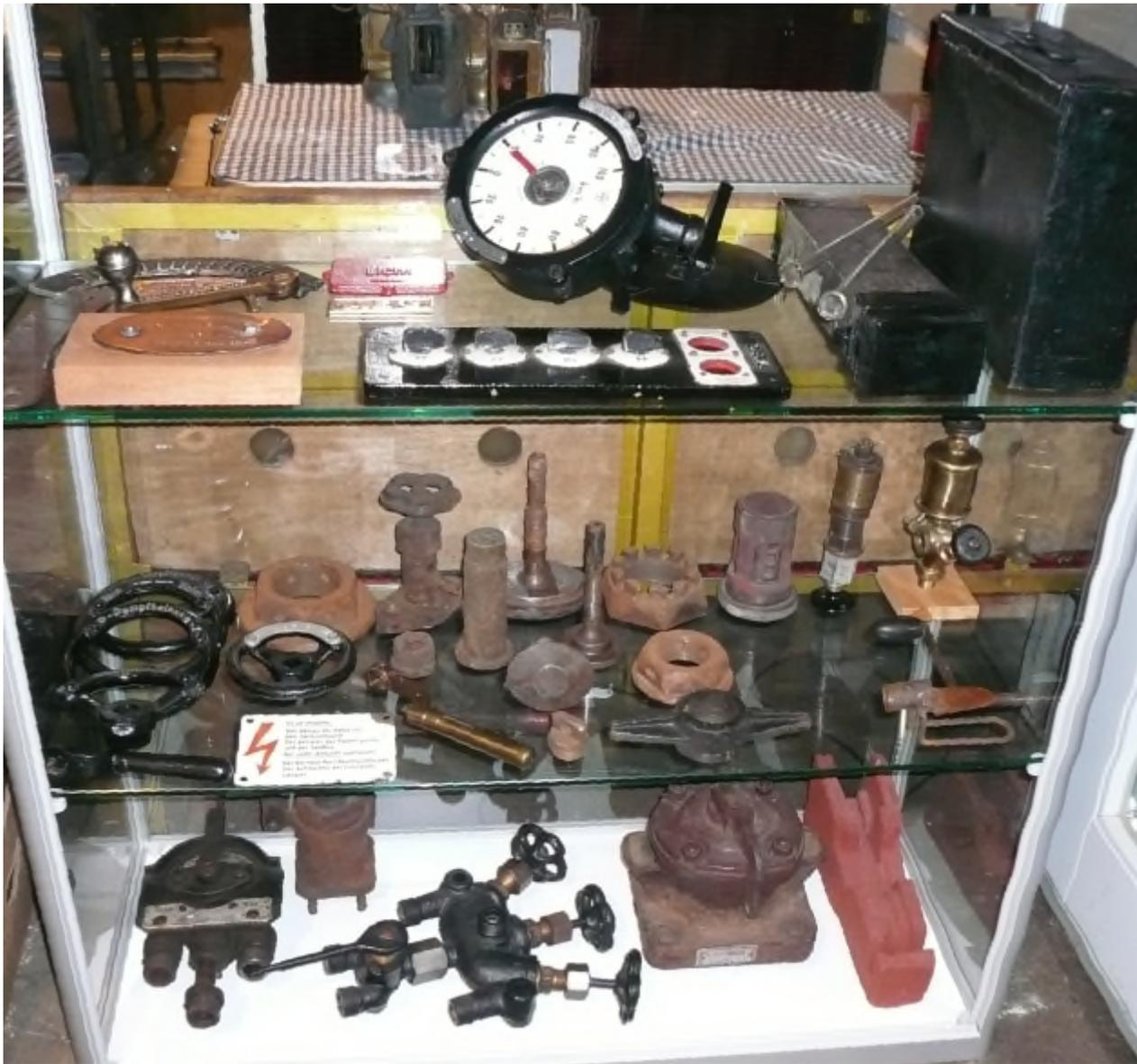
Relikte verschiedener Dampflokomotiven: Handräder, Sandstreuer, Sicherheitsventil, Kesselausmauerung, Handgriffe, Waschluken
